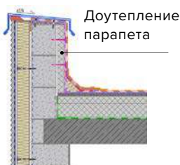
Рис. 2. Решение с доутеплением парапета
