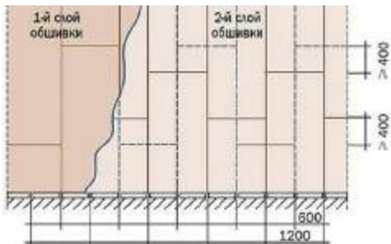
Рис. 7.24. Схема внутренней обшивки стен в два слоя
