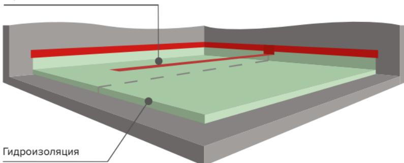
Рис. 5.10. Схема укладки гидроизоляционного слоя
