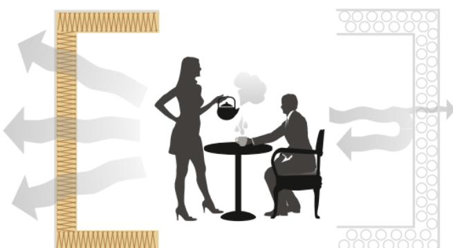
Рис. 1.3. Сравнение помещений, утепленных каменной ватой и пенопластом
