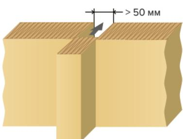
Рис. 1.7. Заполнение зазоров между панелями теплоизоляционного материала
