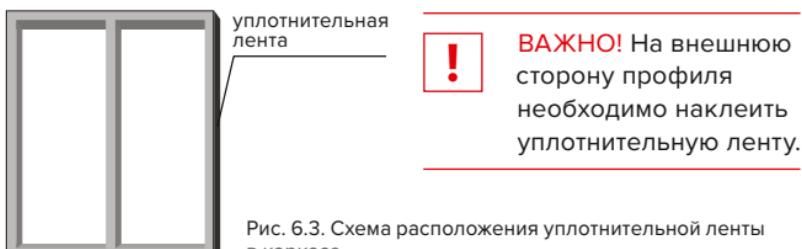
Рис. 6.3. Схема расположения уплотнительной ленты в каркасе
