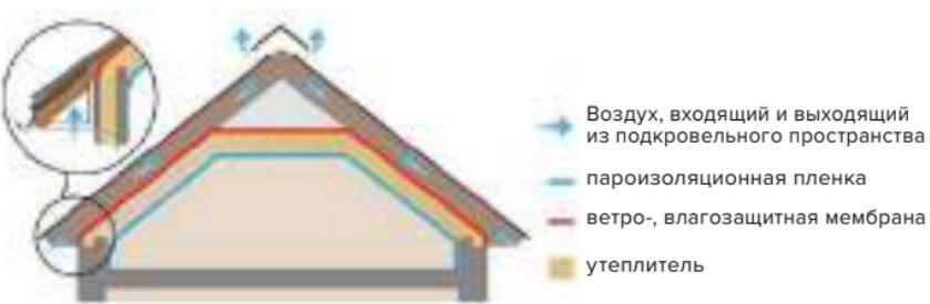
Рис. 4.1. Устройство вентиляции мансарды
