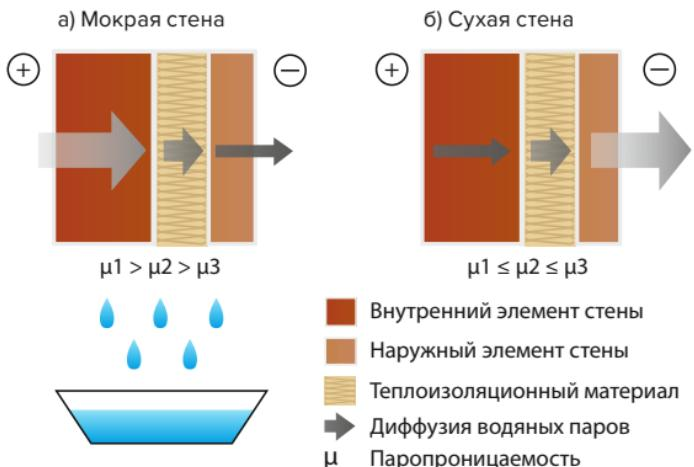
Рис. 1.6. Паропроницаемость слоев конструкции:
