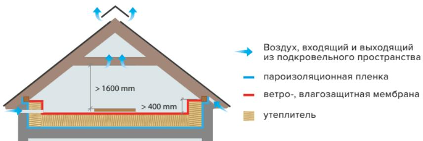
Рис. 4.8. Устройство вентиляции холодного чердака
