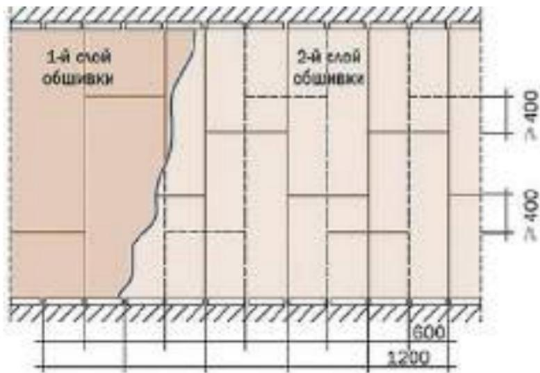
Рис. 6.12. Схема обшивки листами ГКЛ
