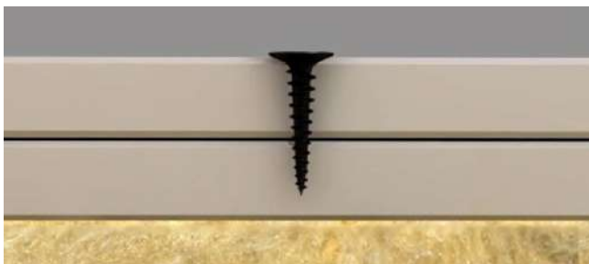
Рис. 5.13. Соединение двух листов сухой стяжки при помощи самореза
