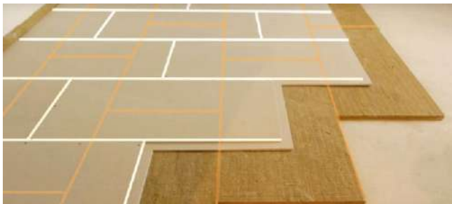
Рис. 5.12. Разбежка швов сухой стяжки и звукоизоляционных плит
